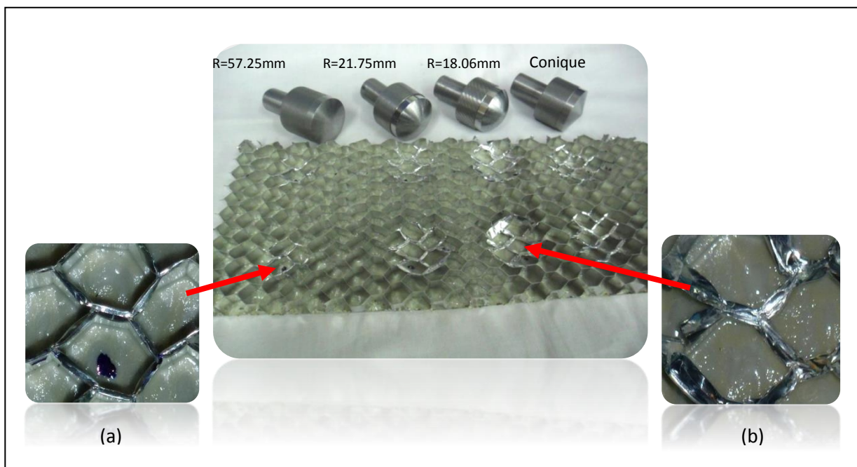
Figure.3.15 : Déformation finale du nid d'abeille Alu-Alu seul en indentation ( 55 \text{ kg/m}^3 ).
