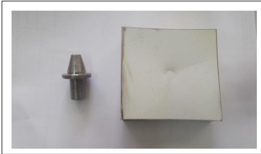
Figure 3.26 : la forme des l'empreinte de l'impacteur
